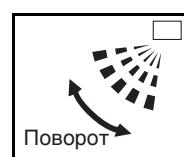
Индикатор НАПРАВЛЕНИЕ ПОТОКА ВОЗДУХА отображает режим поворота заслонок, как показано слева, и при этом направление воздушного потока непрерывно изменяется. (Настройка автоматического поворота)
