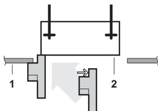
В случае **монтажа с комплектом для забора свежего воздуха** применяйте длинную сторону монтажной направляющей
