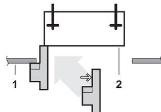
При **монтаже самоочищающейся декоративной панели** пользуйтесь длинной стороной монтажной направляющей, удалив отрывной ярлык
